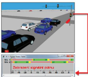
Obr. 11: Vizualizace výsledků simulace v pracovním prostoru z modelování dopravního proudu [29]
