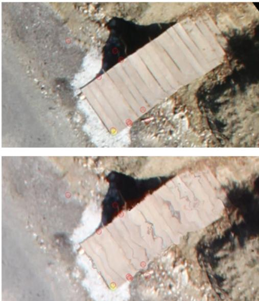
Obr. 1: Vizuální rozdíl vybraného detailu v ortogonalizovaných snímcích z metody SfM (nahoře) a stereofotogrammetrie (dole).
